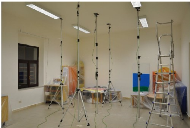
Fotografia 2 - Posizionamento dei trasduttori di spostamento all'intradosso del solaio da monitorare
